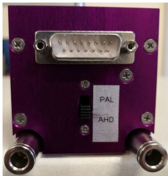
Anschlüsse für Kühlung Schlauch 6mm AD
